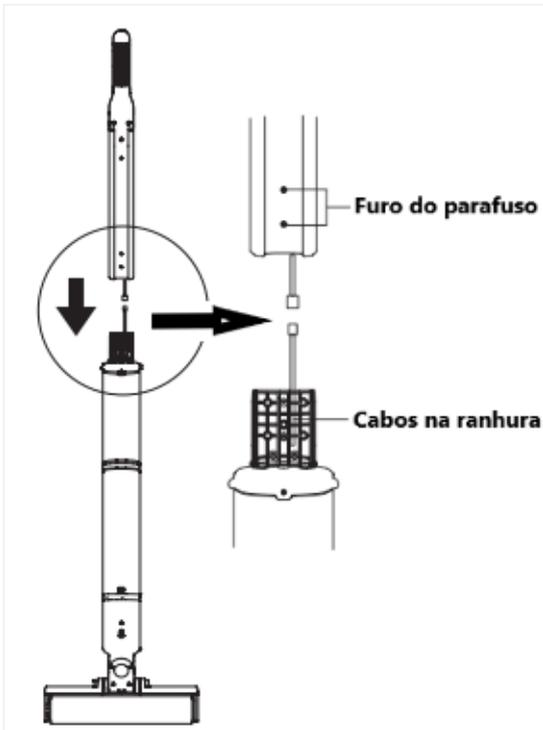
4. Use os parafusos fornecidos na embalagem para fixar a alça e o corpo na posição do orifício do parafuso, conforme mostrado na figura, e então a montagem pode ser concluída.
