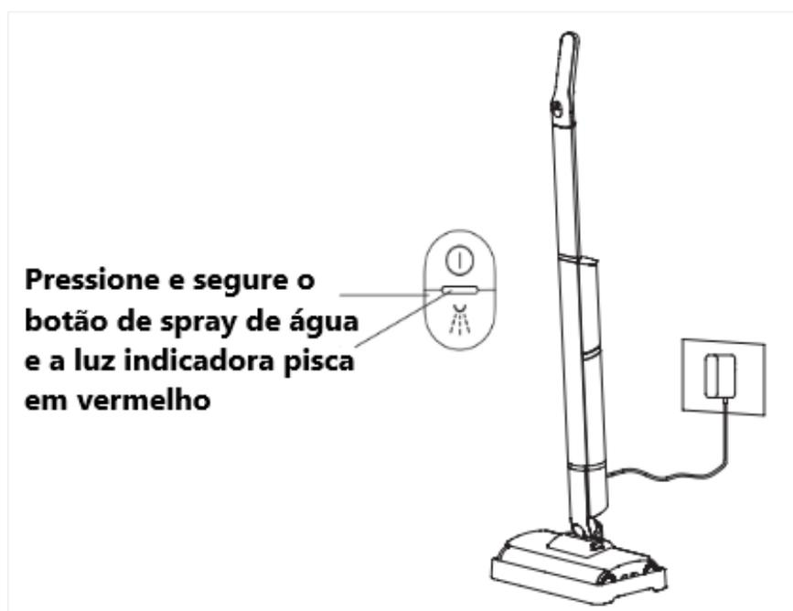
6. Depois de usar este produto, coloque-o no suporte da máquina para evitar que as cerdas molhadas do rolo entrem em contato com o chão por muito tempo, causando danos ao chão e as cerdas.
